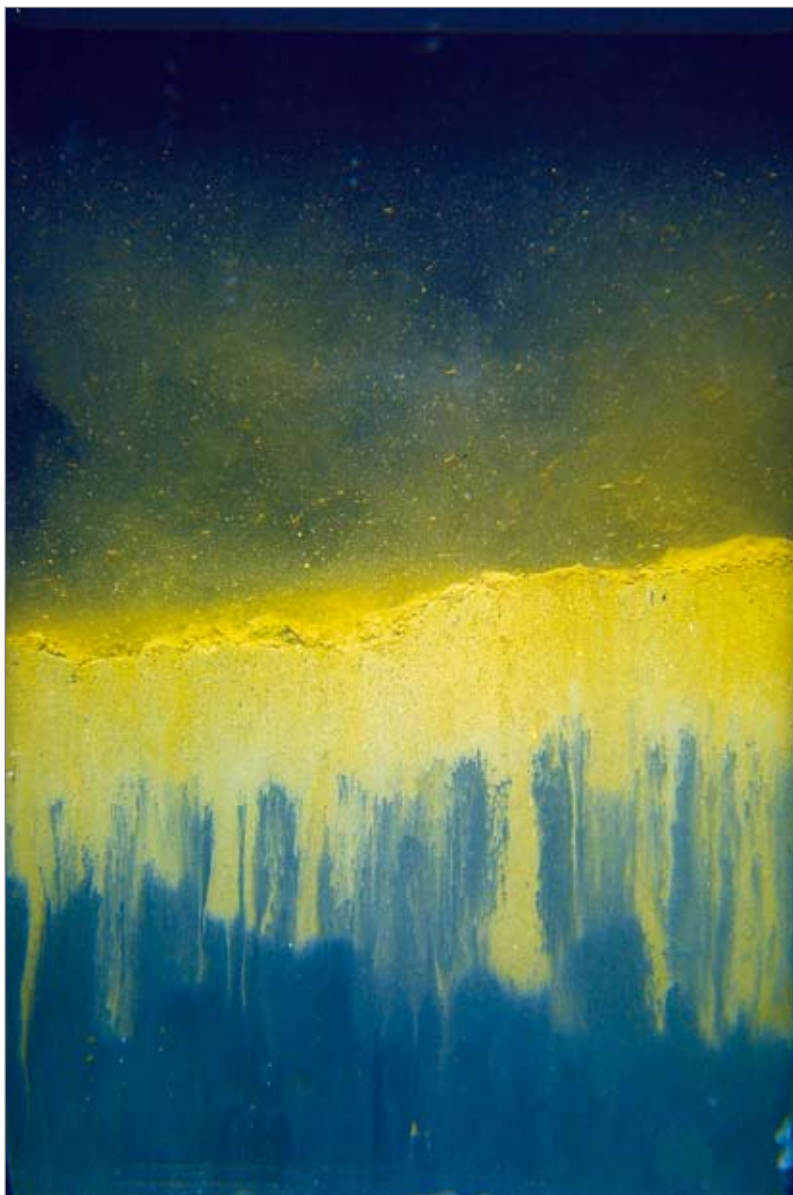
Figur 3. SPI-bild från Marine Monitoring, juni 2002. Sedimentet är oxiderat (gult) ner till ungefär 10 cm djup.
